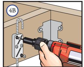
**Nota:** Asegúrese que todos los tornillo se ajustan a su torsión máxima. La tensión adicional puede lograrse con la tuercas en el extremo opuesto del cable de la parte inferior de la unidad saliente o de mirador.
