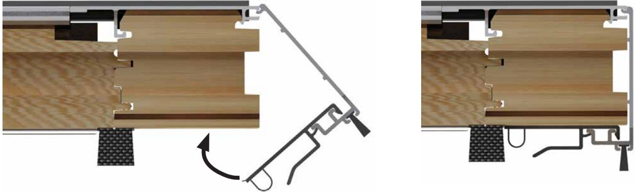
U. Asegúrese de que el empalme esté ajustado completamente hacia arriba contra el dintel del marco. Deberá sostener el empalme en esta posición hasta fijarlo con el primer tornillo.
