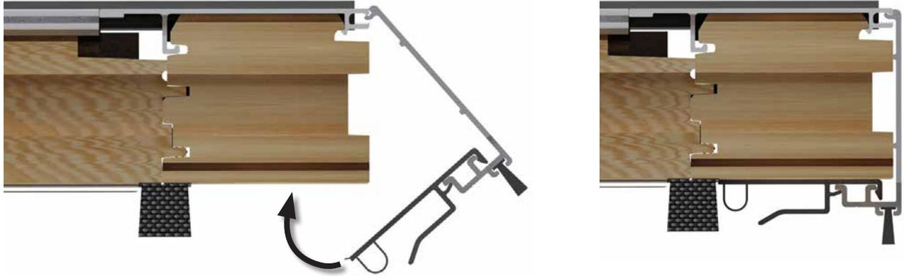
U. Asegúrese de que el empalme esté ajustado completamente hacia arriba contra el cabezal del marco. Deberá sostener el empalme en esta posición hasta fijarlo con el primer tornillo.
