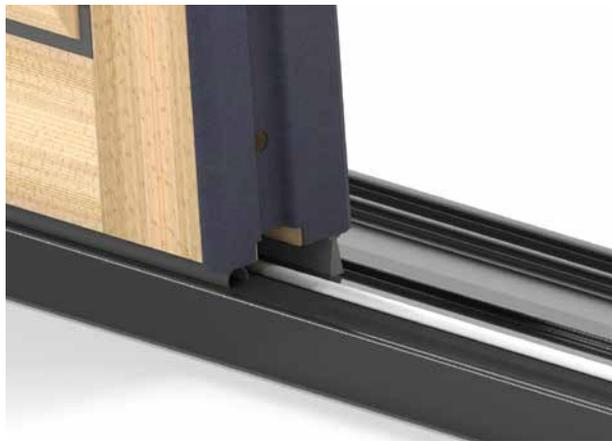
F. Deslice el panel dentro de la jamba fija hasta que se detenga. Asegúrese de que el panel esté completamente colocado dentro de la jamba y, para ello, mida, como se muestra, desde el marco hasta la unión entre el montante y el riel en la parte superior y en la inferior del panel. Debería obtener una medida de 5.30 cm (2 1/16") cuando el panel fijo esté completamente colocado dentro de la jamba del marco fijo.
