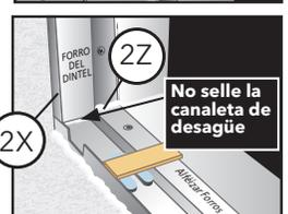
V. Corte dos forros para las jambas de manera que encajen entre el dintel y los forros para alféizar.
