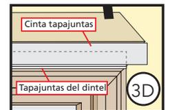
E. Pliegue la lengüeta superior de la barrera resistente al clima.
