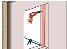
D. **Aplique cinta tapajuntas desde el taburete y sobre el alféizar** de concreto previamente fraguado y sobre 15,24 cm de cada lado. Aplique revestimiento resistente al agua o cinta tapajuntas sobre la batiente de madera. Si usa tapajuntas aplicado en forma líquida, permita que se seque de acuerdo con las recomendaciones del fabricante antes de proceder.
