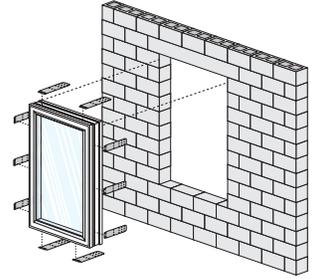
Reemplazo completo del marco sin alterar el ladrillo o el panel de revestimiento para ventanas con marco de bloque
