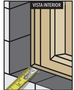
Coloque calzas adicionales en los extremos de los rieles centrales y según sea necesario para garantizar una distancia uniforme entre el marco y los bastidores.
