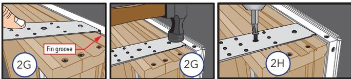
Como alternativa, es aceptable usar dos tornillos #6 de 15,87 mm a través del sujetador con el sujetador sobre su parte posterior y no enganchado en la ranura de la aleta.
