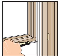
Incline el bastidor inferior hacia adentro para colocar las conexiones de jamba en la canaleta interior de los contrapesos, cerca del contracarril.
