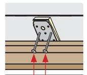
(2) tornillos #6 x 1-1/2" en la abertura sin terminar a través del sujetador
