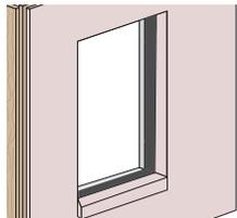
E. **Instale y nivele las calzas del alféizar.** Coloque calzas de 2,54 cm de ancho por 6,35 mm a 9,52 mm de grosor, a 12,7 mm de cada lado. Mantenga las calzas alejadas a 12,7 mm de la superficie interior de la ventana. Coloque calzas adicionales debajo de cada entrepaño y empalme de ventana corrediza. Para ventanas de vinilo, agregue calzas de modo que el espacio máximo sea de 45,72 cm.
