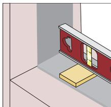
F. **Añada calzas para impedir el movimiento** después de que estén niveladas.
