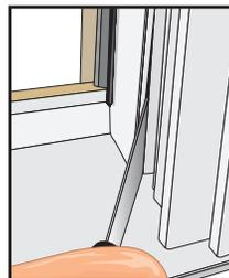
D. Apalanque suavemente la parte inferior del accesorio de la jamba y retírelo completamente.
