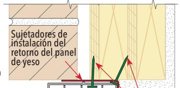
Sujetadores de instalación del retorno del panel de yeso
