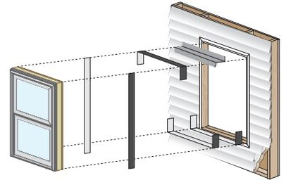
Reemplazo del marco completo en construcciones de mampostería con estuco para ventanas con marco de bloque
