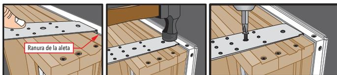
Como alternativa, es aceptable usar dos tornillos de #6 x 5/8" a través del sujetador con el sujetador sobre su parte posterior y no enganchado en la ranura de la aleta.
