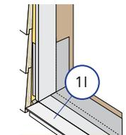
**NOTA:** Para puertas que se abren hacia adentro con una profundidad de marco mayor que 12,7 cm (5"), agregue un tercer trozo de cinta tapajuntas a fin de que se acerque 6,35 mm (1/4") del interior del marco para puerta.
