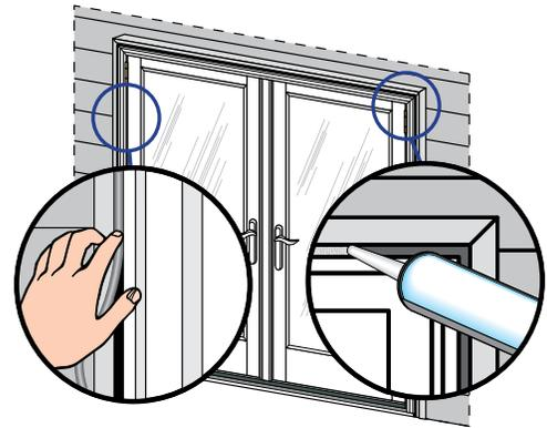
D. Aplique sellador en las cuatro esquinas exteriores y alrededor del ladrillo o panel de revestimiento en la siguiente secuencia:
