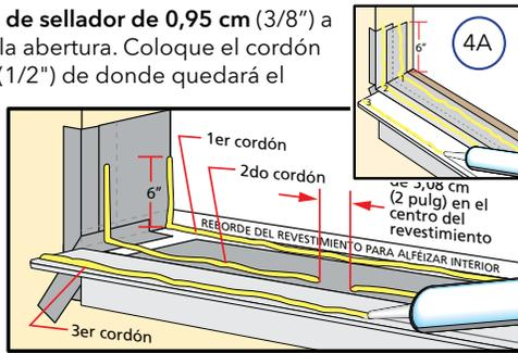
Las variaciones en el diseño del umbral pueden requerir que las líneas de masilla de calafateo se apliquen directamente a la parte inferior del módulo para puerta con el fin de garantizar un sello impermeable necesario. Inspeccione la parte inferior del módulo para puerta con el fin de confirmar que presenta una superficie plana antes de calafatear el área del subsuelo.
