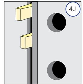
K. **Instale tornillos de instalación de 2-1/2"** a través de la jamba y las calzas hasta insertar en el pasador.
