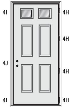
La moldura no debe usarse para sujetar estructuralmente la para puerta. Los sujetadores de la moldura solo deben usarse para sujetar la moldura en su lugar.
