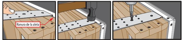
Como alternativa, es aceptable usar dos tornillos de #6 x 5/8 pulg a través del sujetador con el sujetador sobre su parte posterior y no enganchado en la ranura de la aleta.
