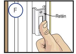
**F. Coloque en la jamba el cerradero con 2 orificios** para tornillos al insertarla en el marco de la jamba en la ubicación deseada. El cerradero puede moverse hacia arriba o hacia abajo para alinearlo con la marca del lápiz. El cerradero quedara fijo en cualquier posición hasta que se asegure con tornillos.
