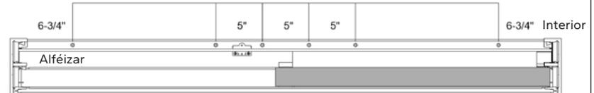
El borde exterior del alféi-zar debe contar con soporte para cumplir los valores de rendimiento. Aplique soporte de alféi-zar de aluminio Pella o bloques de madera, según se requiera, para dar soporte al borde exterior del marco de la puerta.
