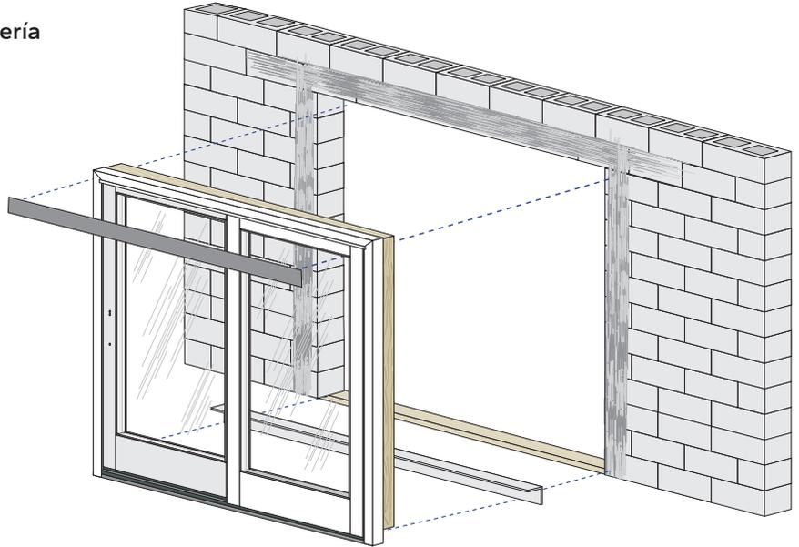
Reemplazo completo del marco sin alterar el ladrillo o el panel de revestimiento para puertas corredizas con marco de bloque
