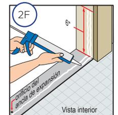
Nota: Si no sella adecuadamente los tornillos de fijación del alféizar y placa de alféizar, es posible que el agua penetre en el interior del hogar.
