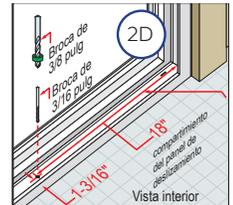
E. Ajuste la puerta. Asegúrese de que la puerta esté a plomo, a escuadra y nivelada. Marque las ubicaciones de las anclas de expansión y taladre. Marque el interior del marco para puerta en el alféizar para mostrar una demarcación para la colocación de sellador. Retire y coloque la puerta a un lado con cuidado.
