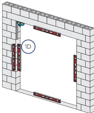
E. Mida y marque la abertura donde se ubicará el interior de la nueva puerta. Considere el tamaño de la cavidad de la pared (si corresponde) y una superposición mínima de 3/4 pulg en el revestimiento de ladrillo o los materiales de la pared acabada para el sellador del perímetro exterior.
