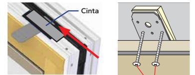
Deslice los sujetadores en las ranuras en T desde las esquinas del marco y adhiéralos con cinta. Tornillo #6 x 1-1/2 pulg
