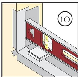
P. **Fije calzas para impedir el movimiento** después de que estén nivelados.
