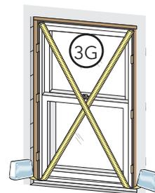
H. **Revise que la ventana esté a plomo y a escuadra,** y nivelada. Haga todos los ajustes necesarios a las calzas y termine de instalar los tornillos para marcos o las anclas de expansión de los sujetadores.
