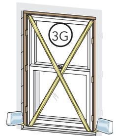
H. **Revise que la ventana esté a plomo y a escuadra,** y nivelada. Haga todos los ajustes necesarios a las calzas y termine de instalar los tornillos para marcos o las anclas de expansión de los sujetadores.
