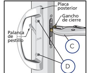
**F. Gire a 180° y vuelva a instalar la cerradura.** Inserte la cerradura embutida en el panel de la puerta con el tornillo de ajuste del seguro ubicado en la parte inferior, luego incline la parte superior hacia adentro y levante la cerradura para colocarlo en posición. Inserte los dos tornillos de montaje en los orificios de montaje de la cerradura.
