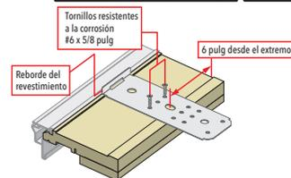
Como alternativa, es aceptable usar dos tornillos de #6 x 5/8 pulg a través del sujetador con el sujetador sobre su parte posterior y no enganchado en la ranura de la aleta.
