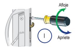
**H. Ajuste el gancho de cierre girando el tornillo** de ajuste de la cerradura para puerta en dirección de las manecillas del reloj para aflojar o en dirección contraria a las manecillas del reloj para apretar hasta que la cerradura embutida esté adecuadamente alineada, la puerta se bloquee con facilidad y haya un movimiento menor a 1/16 pulg cuando se cierra la puerta.
