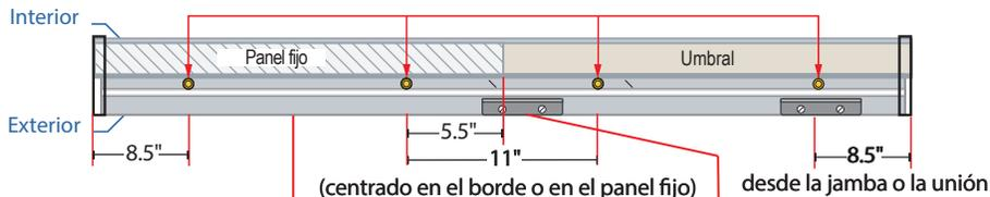
El borde exterior del alféizar debe contar con soporte para cumplir los valores de rendimiento. Aplique soporte de alféizar de aluminio Pella o bloques de madera, según se requiera, para dar soporte al borde exterior del marco de la puerta.
