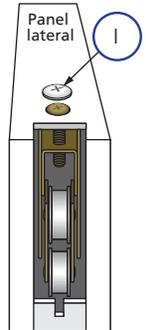
*Nota: La palanca del pestillo debe encajar en la ranura en la parte lateral del ensamble de la cerradura embutida.*
