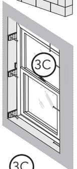
**Abertura doble:** corte las bandas de contracarril (si corresponde) y retire los espaciadores de transporte. Abra, cierre e incline los bastidores para comprobar que funcionan bien. Verifique que la distancia entre el bastidor y el marco sea la misma desde la parte superior hasta la inferior.
