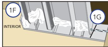
G. **Si se cortaron los orificios de drenaje del alféizar existente**, taladre nuevos orificios de drenaje en las jambas de la puerta existente. Asegúrese de taladrar orificios de drenaje en todas las patas de las jambas verticales, excepto en la pata interior.
