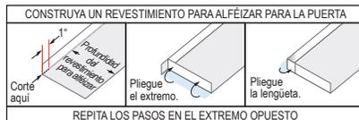
Ajuste el revestimiento para alféizar y la puerta en la abertura.
