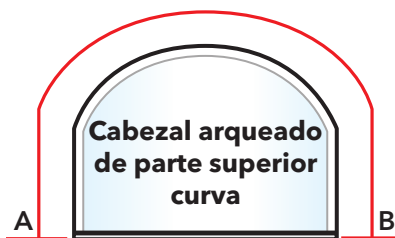
Cabezal arqueado de parte superior curva Mida desde el punto A hasta el punto B.
