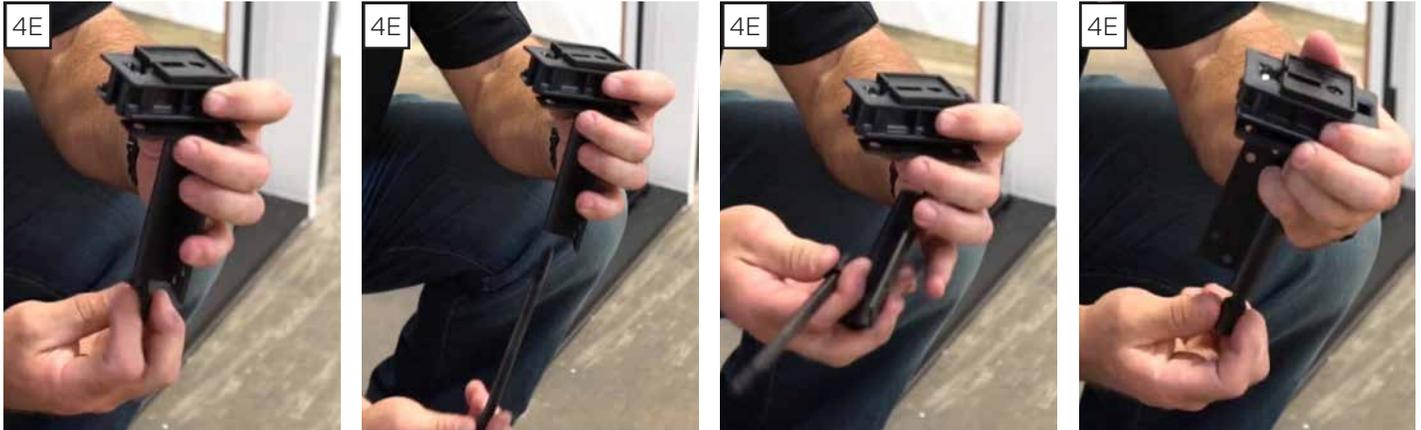
F. Después de volver a armar la polea, es necesario retirar el tornillo de fijación superior aproximadamente 4,76 mm. Esto permitirá que el poste baje lo suficiente para lograr un espacio libre adecuado.
