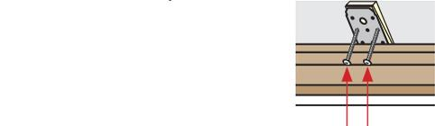
(2) tornillos #6 x 1-1/2" en la abertura sin terminar a través del sujetador
