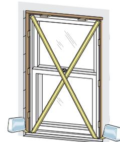
**Abertura doble:** corte las bandas de contracarril (si corresponde) y retire los espaciadores de transporte. Abra, cierre e incline los bastidores para comprobar que funcionan bien. Verifique que la distancia entre el bastidor y el marco sea la misma desde la parte superior hasta la inferior.
