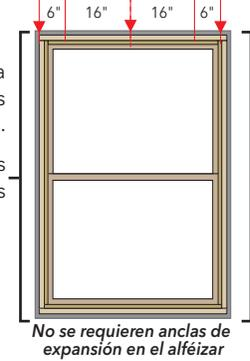
Coloque tornillos para marcos o sujetadores en los lugares indicados.
