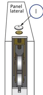
I. **Solo puertas de alto rendimiento:** Retire los bloqueos del riel superior del panel de la puerta y vuelva a instalarlos en el extremo opuesto del panel.
