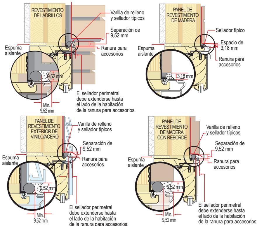
**Aviso** El método de construcción del revestimiento, el tapajuntas y la aplicación de sellador puede variar según el diseño del alféizar de la abertura y las condiciones exteriores de la superficie de apoyo. Es importante considerar la exposición a la intemperie, la proximidad de la superficie de apoyo exterior al alféizar de la puerta y confirmar que las superficies exteriores impermeables tengan una inclinación adecuada en dirección opuesta a la puerta.
