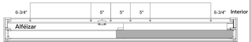
El borde exterior del alféizar debe contar con soporte para cumplir los valores de rendimiento. Aplique soporte de alféizar de aluminio Pella o bloques de madera, según se requiera, para dar soporte al borde exterior del marco de la puerta.
