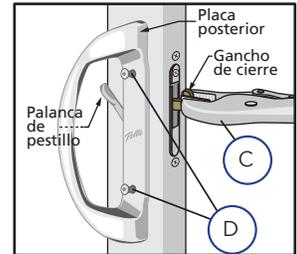
F. **Gire a 180° y vuelva a instalar la cerradura.** Inserte la cerradura embutida en el panel de la puerta con el tornillo de ajuste del seguro ubicado en la parte inferior, luego incline la parte superior hacia adentro y levante la cerradura para colocarlo en posición. Inserte los dos tornillos de montaje en los orificios de montaje de la cerradura.
