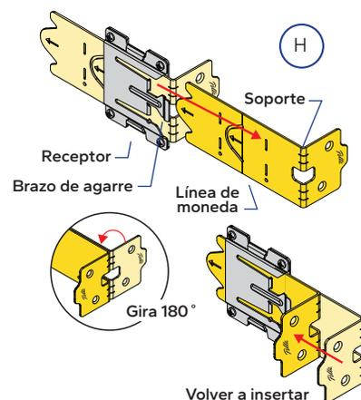
**Nota:** cualquier abrazadera en la parte inferior de la ventana se puede quitar y volver a insertar después de que la ventana esté parcialmente colocada en la abertura.
