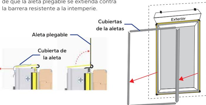
**AVISO** Fíjate si la aleta plegable y las cubiertas de las aletas presentan daños. Si es necesario, agrega cinta tapajuntas para reparar las aletas o las esquinas de las aletas dañadas.
