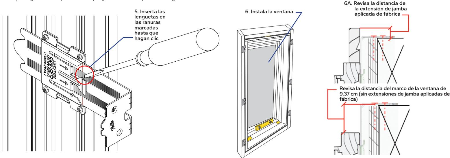
7. **Si la ranura marcada está en la ubicación deseada de la ventana dentro del sistema de la pared,** marca el resto de las abrazaderas de anclaje de la ventana necesarias y continúa con la instalación de ventanas adicionales. De lo contrario, ajusta la lengüeta del brazo de agarre a la ranura adecuada y vuelve a marcar las abrazaderas adicionales según sea necesario.
