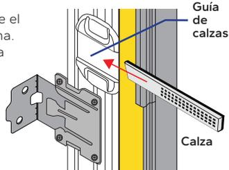
B. **Retira las cubiertas de las aletas.** Asegúrate de que la aleta plegable se extienda contra la barrera resistente a la intemperie.
