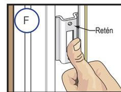
**F. Coloque en la jamba el cerradero con 2 orificios** para tornillos al insertarla en el marco de la jamba en la ubicación deseada. El cerradero puede moverse hacia arriba o hacia abajo para alinearlo con la marca del lápiz. El cerradero quedara fijo en cualquier posición hasta que se asegure con tornillos.
