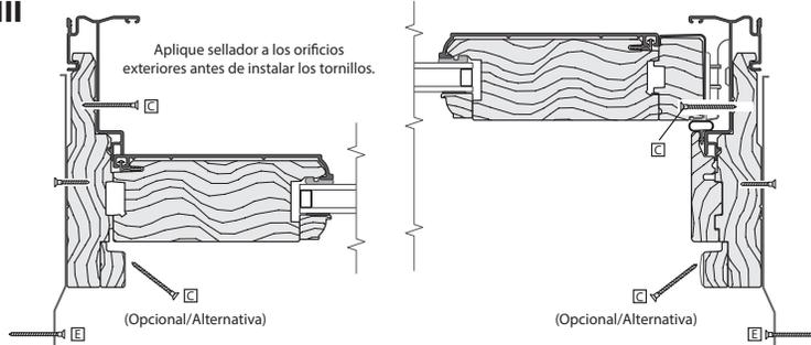
Inserte los tornillos a través de los tapones en cada orificio preperforado o taladre orificios guía, si no hay ninguno. Aplique sellador a los orificios antes de instalar los tornillos.
