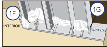
**NOTA: Asegúrese de que todos los orificios de drenaje, nuevos o existentes, estén abiertos antes de proceder con la instalación.**
