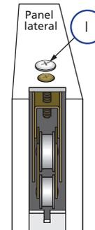
*Nota: La palanca del pestillo debe encajar en la ranura en la parte lateral del ensamble de la cerradura embutida.*
