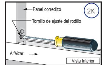
**NOTA:** Para las puertas con resistencia contra impactos severos o con vidrio de cristal triple utilice una palanca pequeña para levantar el panel mientras gira el tornillo de ajuste. Esto evitará que las rosca se dañen.
