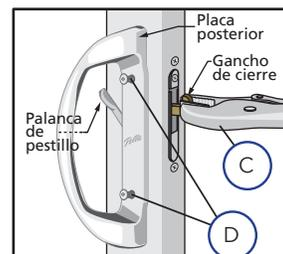
**F. Gire a 180° y vuelva a instalar la cerradura.** Inserte la cerradura embutida en el panel de la puerta con el tornillo de ajuste del seguro ubicado en la parte inferior, luego incline la parte superior hacia adentro y levante la cerradura para colocarlo en posición. Inserte los dos tornillos de montaje en los orificios de montaje de la cerradura.
