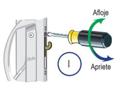
**H. Ajuste el gancho de cierre girando el tornillo** de ajuste de la cerradura para puerta en dirección de las manecillas del reloj para aflojar o en dirección contraria a las manecillas del reloj para apretar hasta que la cerradura embutida esté adecuadamente alineada, la puerta se bloquee con facilidad y haya un movimiento menor a 1/16 pulg cuando se cierra la puerta.
