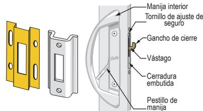
**E. Coloque en la jamba el cerradero con 4 orificios** para tornillos para que la parte superior de la ranura quede alineada con la marca de lápiz. Con un tornillo inicial #6 x 1/2 pulg inserte para unir uno de los orificios ranurados del cerradero.
