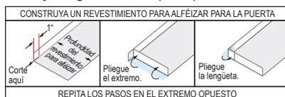
Ajuste el revestimiento para alféizar y la puerta en la abertura.
