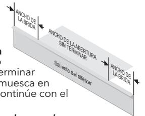
**NOTA: Si el nuevo marco para puerta es más profundo que el marco para puerta existente, será necesario cortar el material para pisos interiores, para permitir que la puerta con bridas al ras haga contacto con el marco para puerta de aluminio existente.**
