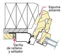
A. Inserte la varilla de relleno en el espacio que está alrededor de la ventana, con la profundidad suficiente para obtener un espacio de 3/8 de pulgada entre la varilla de relleno y la cara exterior de la ventana.
