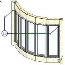
C. Ponga la ventana a plomo y a escuadra. Coloque las calzas a 1 pulgada de las partes inferior y superior de la ventana, entre ésta y los laterales de la abertura. Ajuste las calzas lo necesario para que la ventana quede a plomo y a escuadra en la abertura. Coloque las calzas en el punto medio de los lados de la ventana.
