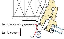
G. Utilizando los clavos galvanizados de 2 pulgadas, coloque un clavo a través de la pata plana de la cubierta de la jamba, a 6 pulgadas desde la parte superior y la parte inferior, y otro clavo en el centro.
