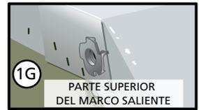
H. **Inserte el extremo no roscado del cable en el orificio del soporte del cable inferior.** Pase el cable por el entrepaño del marco saliente y sáquelo por el orificio del soporte superior. El extremo roscado del cable preparado con la arandela y la tuerca se detendrán contra el costado inferior del marco saliente. Repita el procedimiento para el otro lado.
