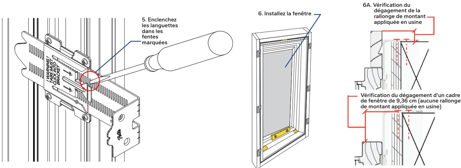
7. **Si la fente marquée donne l'emplacement souhaité pour la fenêtre dans le système mural, marquez le reste des supports d'ancrage de fenêtre nécessaires et poursuivez les installations de fenêtre supplémentaires.** Dans le cas contraire, alignez la languette du bras de blocage à la bonne fente et marquez de nouveau les supports supplémentaires, au besoin.
